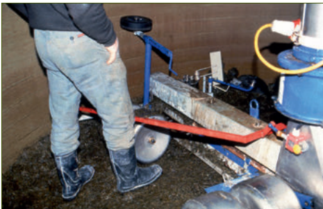
Silofräsen sind eine grosse Arbeitserleichterung. Sie müssen mit Not Aus ausgerüstet sein.
