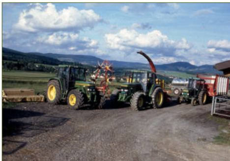
Silierkette mit Scheibenmäher, Feldhäcksler und Dosierwagen
