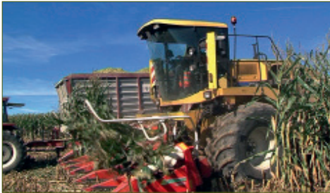
Die Silierkette ist auf die Leistung des Häckslers abzustimmen
